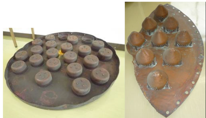
磐田工場所蔵 蒸留塔棚段
